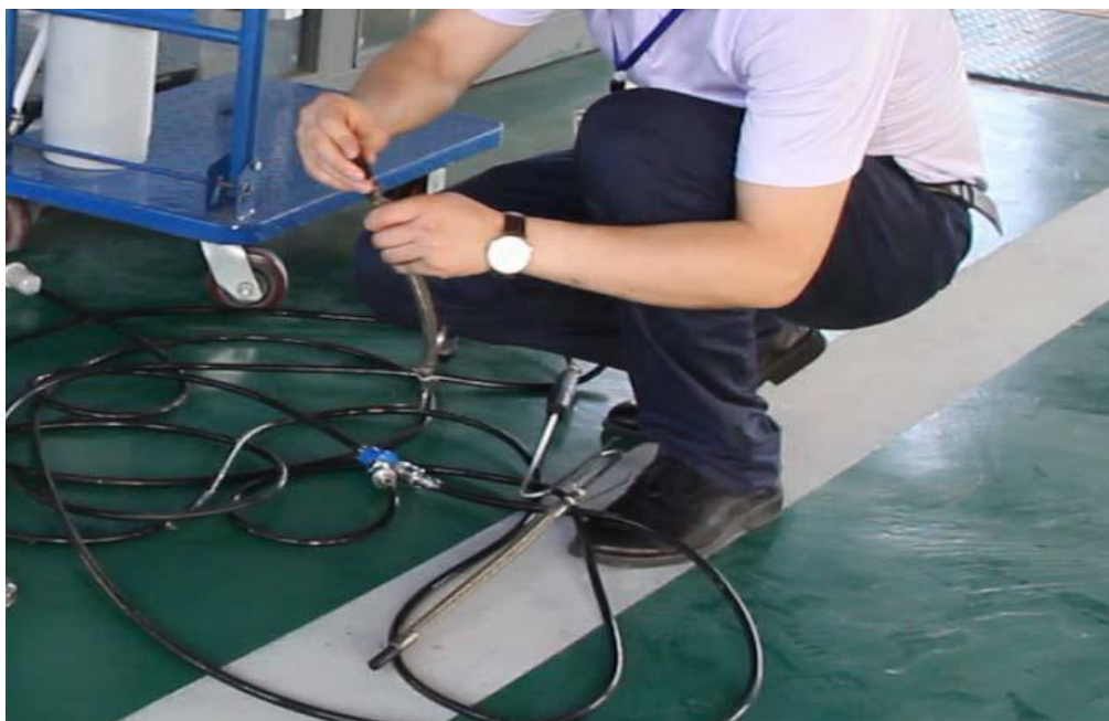
图 A.6 密封取样探头示意图
