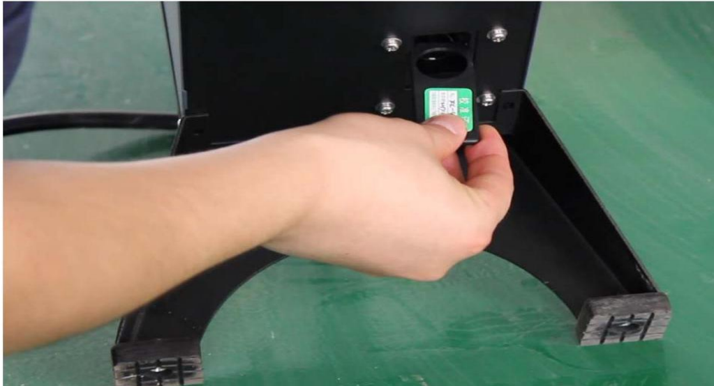
图 A.9 滤光片插入不透光烟度计插槽
