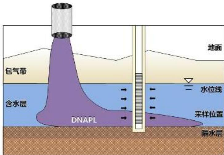
图 1-2 地下水样品采集示意图
