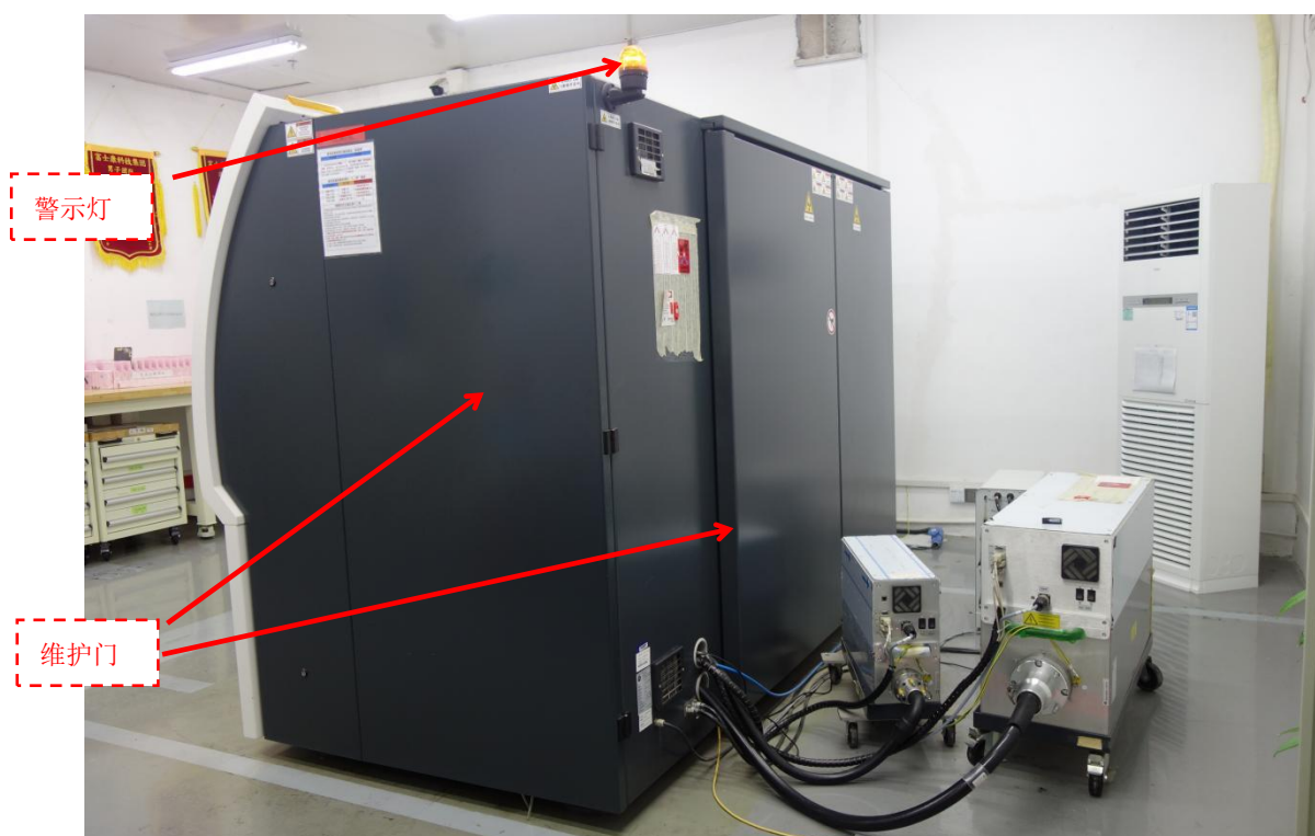
图 9-3 本项目工业 CT 后部示意图（背面）
