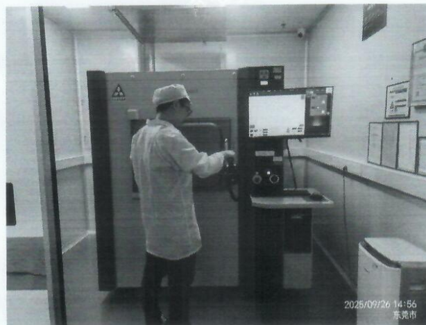
SMX-6000SP 型微焦点 X 射线透视检查装置检测图片
