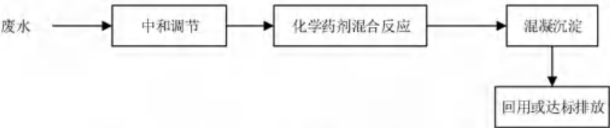
图 7.2-3 铁矿山重金属废水混凝处理工艺
