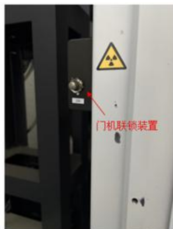
检修门（左侧）门机联锁装置
