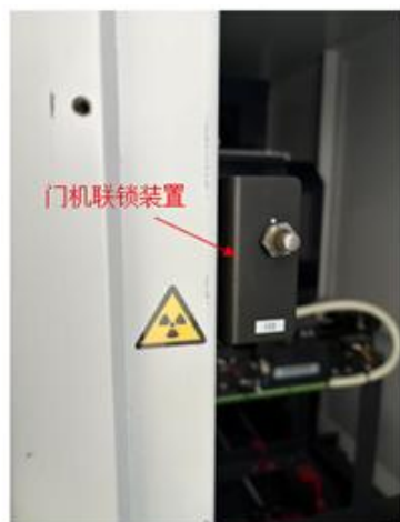
检修门（右侧）门机联锁装置
