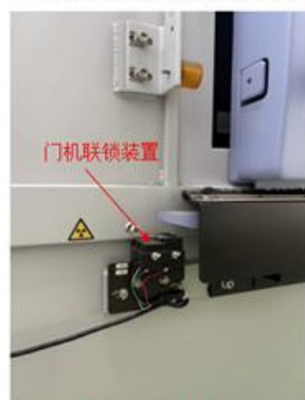
装载门门机联锁装置
