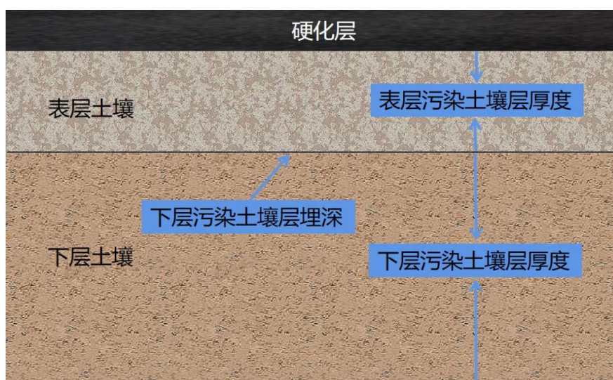
图 3-1 表层污染土壤层厚度、下层污染土壤层埋深和下层污染土壤层厚度示意图
