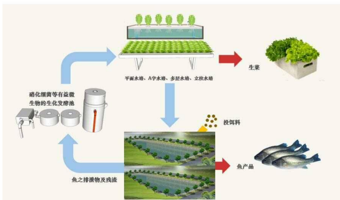
图 8 温室鱼菜共生尾水处理工艺示意图
